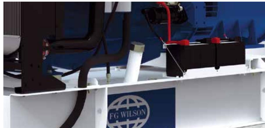
Um bocal de abastecimento com 3" de largura facilitam o acesso e o abastecimentos, enquanto as válvulas de drenagem do líquido de arrefecimento e do óleo propiciam acesso conveniente para manutenção. A estrutura da base também facilita o ponto de arrastar como padrão ajudando o transporte e reduzindo o risco de danos durante a colocação na empilhadeira e outros tipos de manuseio.
