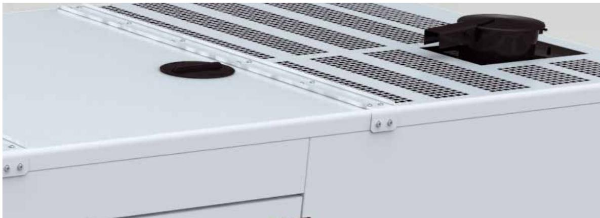
Todas as juntas de teto são reforçadas com juntas sobrepostas, utilizando vedações de borracha butílica, oferecendo proteção inigualável contra a entrada de água em condições extremas. Bordas curvas garantem uma estrutura rígida e de aspecto esteticamente agradável à canópia. O radiador é acessado via uma tampa contra chuva de montagem rente com selo de compressão – uma proteção a mais contra a entrada de água.
